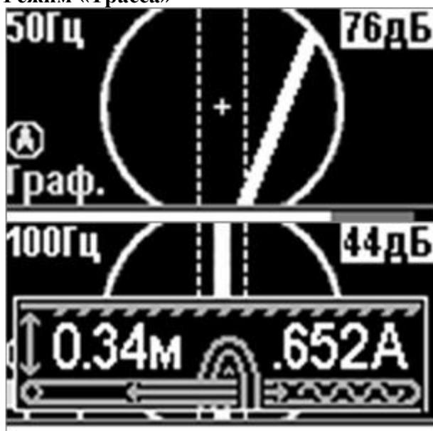
В режиме «Трасса» на индикаторе отображается положение оси трассы относительно прибора, глубина залегания и сила тока в коммуникации. Поиск трассы происходит в полуавтоматическом режиме наглядно и быстро.
