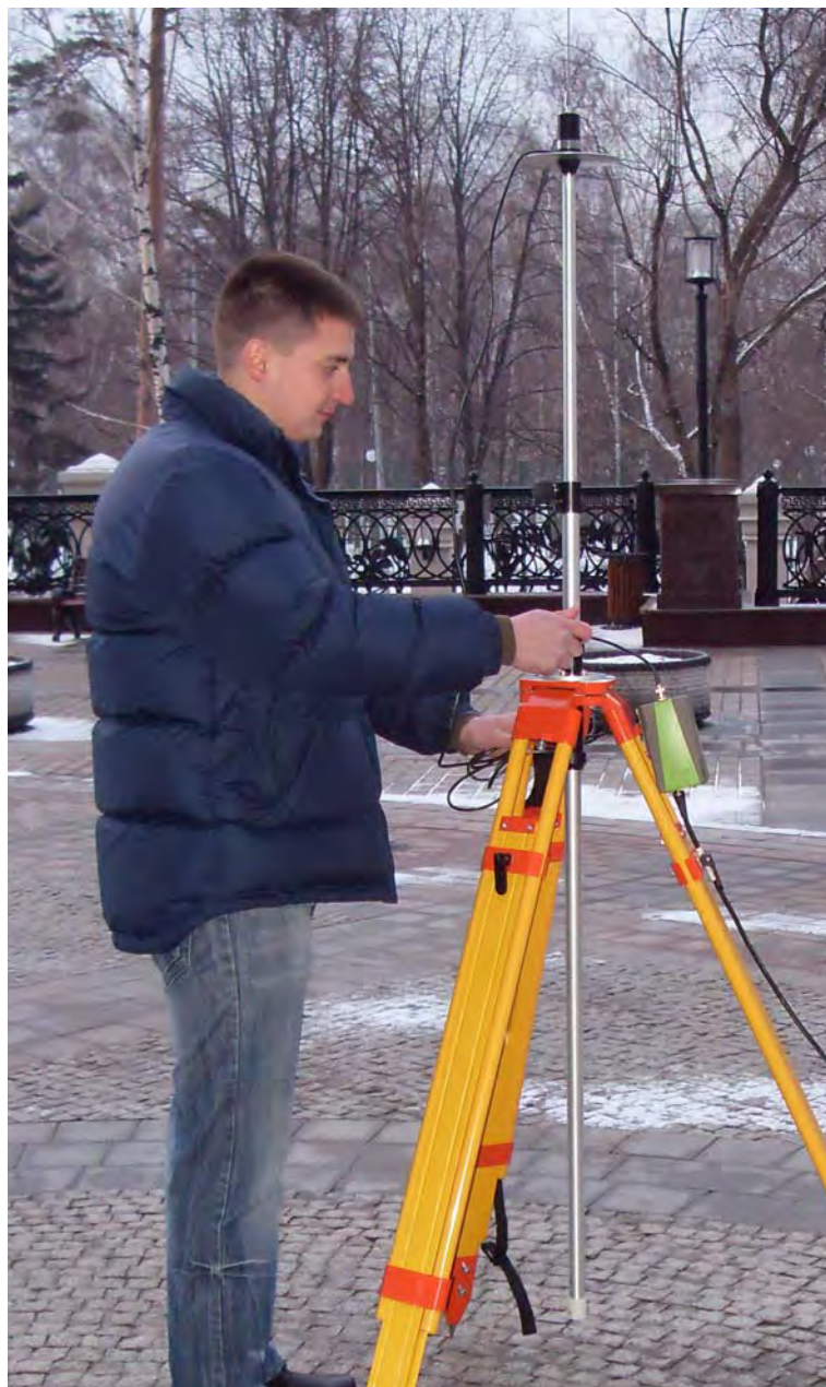
Рисунок 3-1. Пример установки НРТ435ВТ
