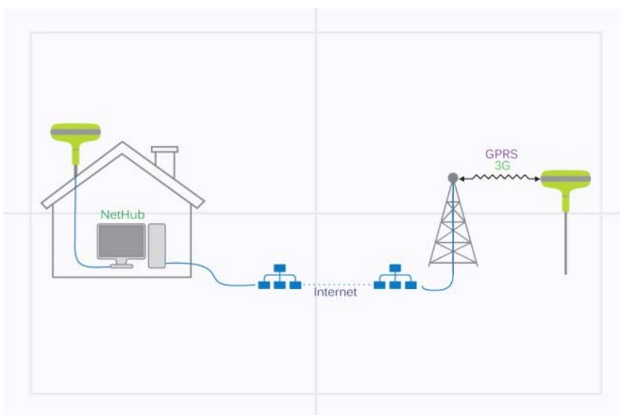
Рисунок 6. Вариант 3С – стационарная база подключена компьютеру с NetHub, с которой ровер связывается через GPRS/3G модем.
